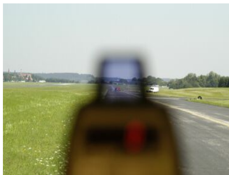
Bilder unten: Die Situation, der Blick durch die Visiereinrichtung (ohne Vergrößerungsoptik) und das Messergebnis: Es stammt vom Kastenwagen dahinter.
