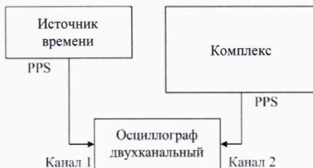
Рисунок 1 – Схема проведения измерений при определении погрешности синхронизации внутренней шкалы времени комплекса с национальной шкалой времени UTC (SU)
