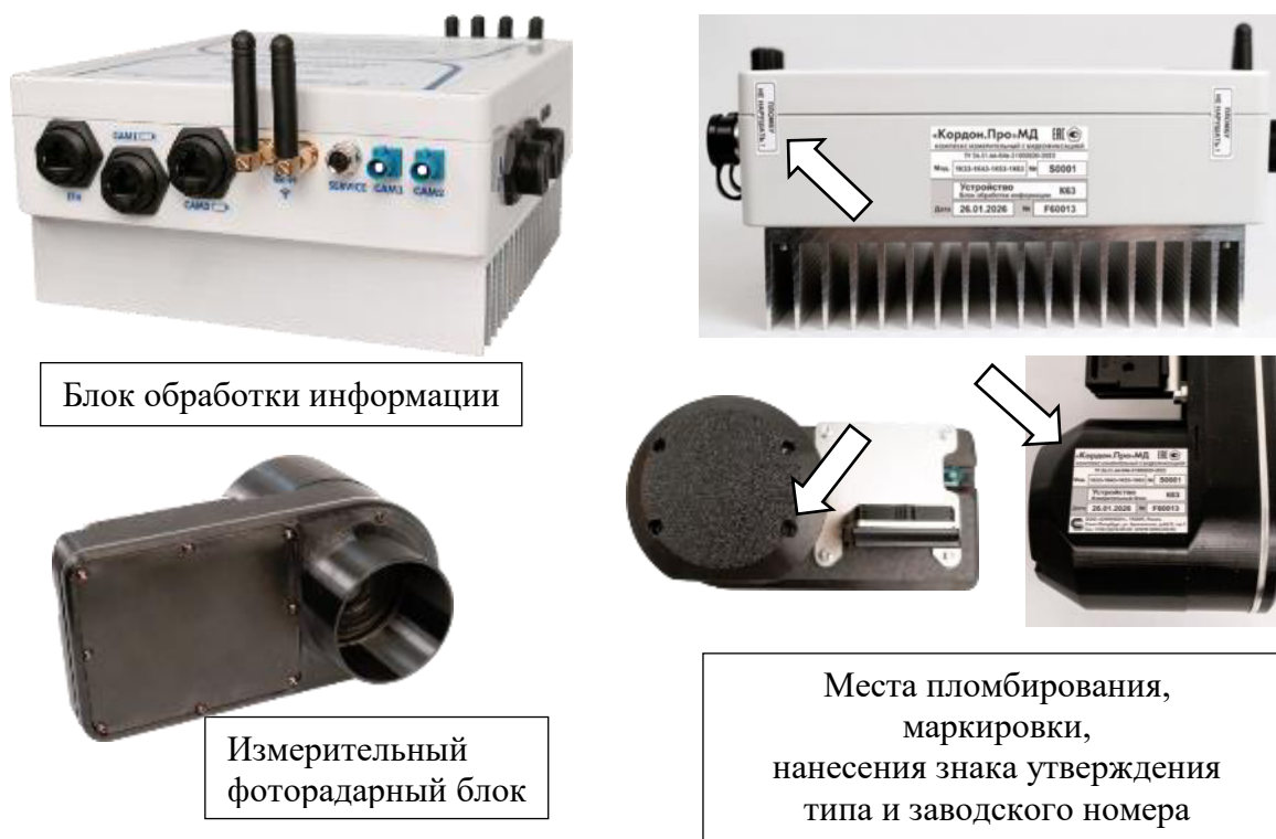
Рисунок 4 – Общий вид устройств K63 и K66 с указанием места пломбирования, маркировки, нанесения знака утверждения типа и заводского номера
