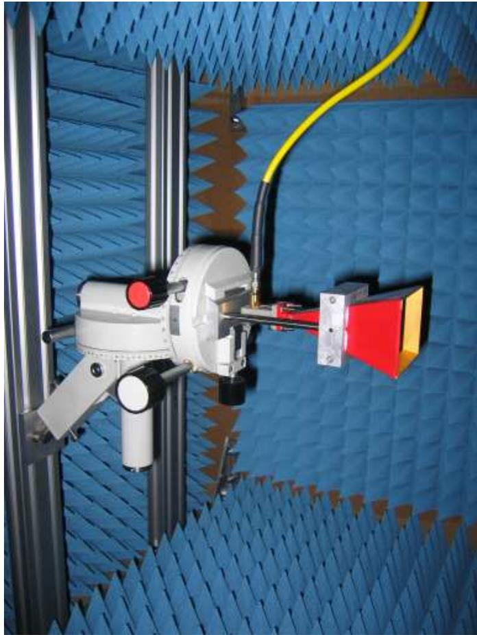
**Figura 22** - Antena Corneta em Oposição ao Sistema Giratório Motorizado
