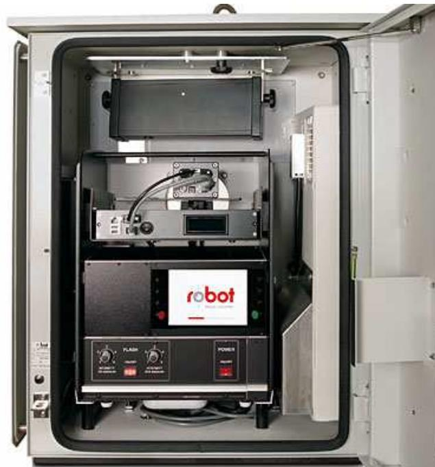
**Figura 19** - Montado numa Caixa Fechada com Proteção Térmica
